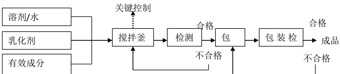
1、将水/溶剂、乳化剂计量后投入反应釜中搅拌至溶解均匀；
